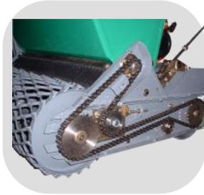
**Entrainement par chaîne des rouleaux avant et arrière ainsi que de l'agitateur de graine.**
